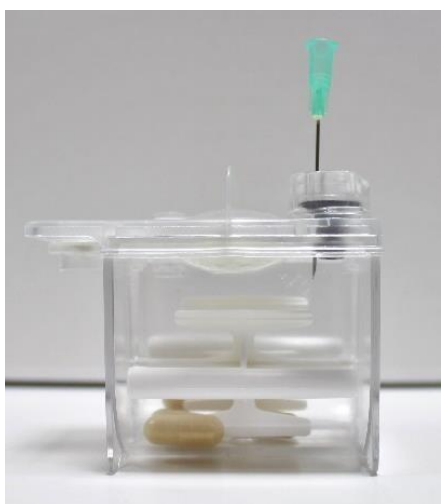
Rys. 5: Igła do wyrównywania ciśnienia wbita w gumowa przegrodę pojemnika do testów
