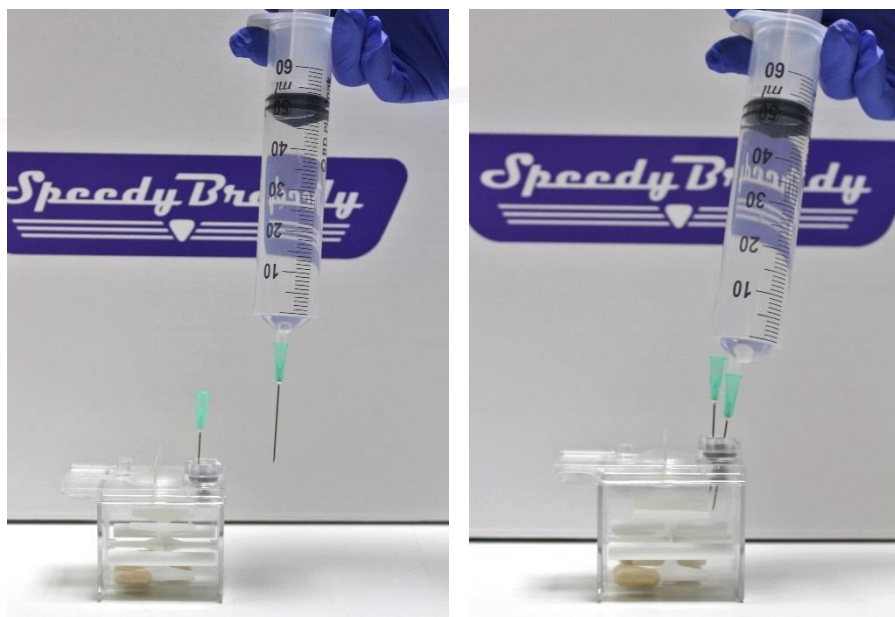
Rys. 6: Wprowadzanie próbki przez samuszczelniającą się przegradę gumową
