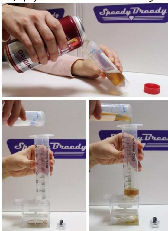
Rys. 7: Dodawanie do pojemnika piwa i sterylnej wody
