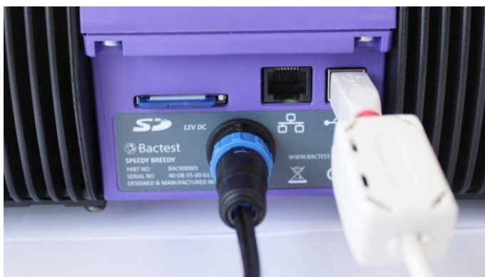
Rys. 3: Tył urządzenia Speedy Breedy z kablami i włożoną kartą SD.
